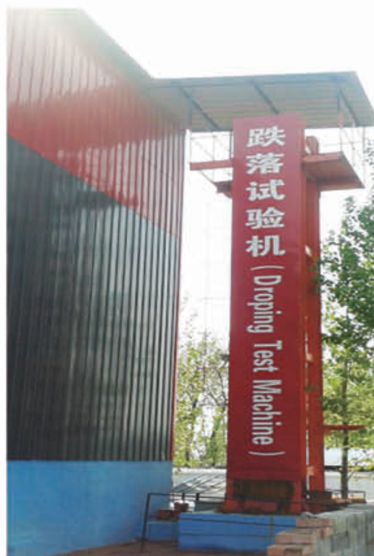
8 米高度落球试验机 Dropping Test Machine(8m)
